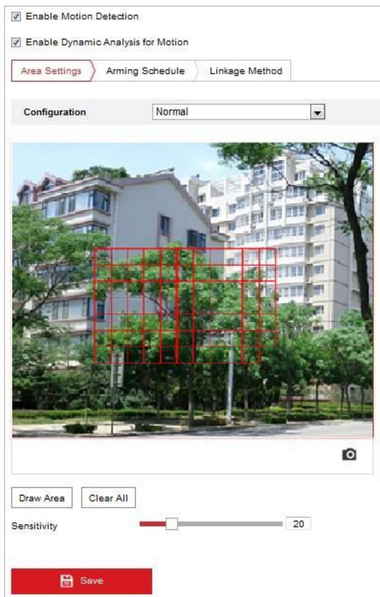
Рисунок 5-9 Настройки обнаружения движения - Нормальный режим
