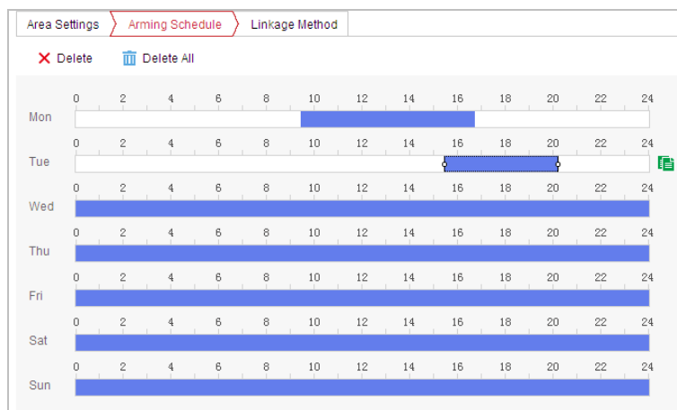
Рисунок 5-12 Настройка расписания поставновки на охрану
